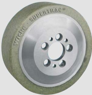
SuperTrac® ist eine Wicke hauseigene Weiterentwicklung der bekannten Vulkollan®-Bereifung (NDI), basierend auf dem Rohstoff Desmodur® 15 der Bayer AG® Leverkusen. Durch die Zugabe von weichen Elastomerpartikeln haben SuperTrac®-Bereifungen eine vorteilhafte Traktion, speziell im Inneneinsatz, ohne die bewährten Vulkollan®-Eigenschaften in größerem Umfang zu verlieren.
